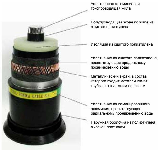
Рис. 3. Конструкция силового высоковольтного кабеля с волоконно-оптическим модулем
