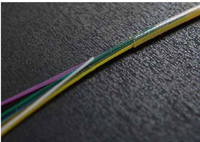
Рис. 9. Компактный волоконно-оптический блок из 12 волокон
