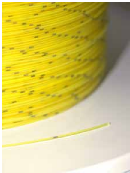
Рис. 2 Окрашенное оптическое волокно
