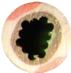
Рис. 6. Провод сечением 0,35 мм 2 с двухслойной изоляцией
