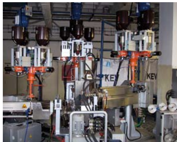
Рис. 2. Экструзионная группа с тремя экструдерами и гравиметрической системой дозирования
