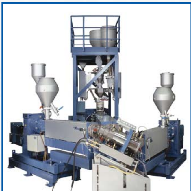
Рис. 1. Экструзионная группа наклонной линии вулканизации
