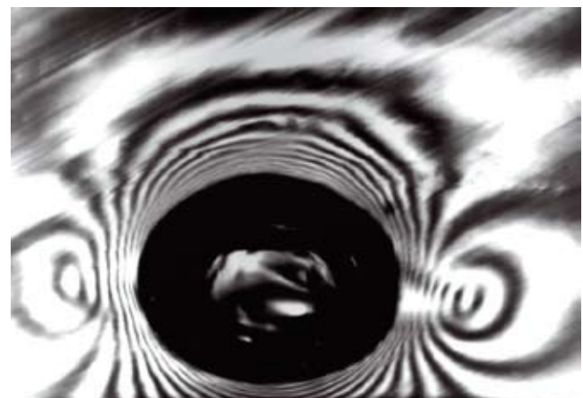
г) крупная (1 мм) газовая полость в изоляции. Интерференционные полосы, окружающие полость, свидетельствуют о значительных механических напряжениях в материале
