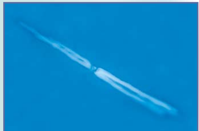
Рис. 5. Водный триинг в изоляции кабеля на напряжение 110 кВ после 15 лет эксплуатации. Фото получено в свете собственной люминесценции
