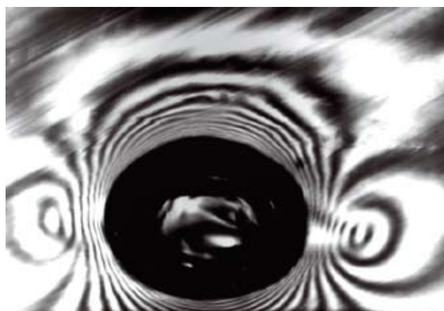
г) крупная (1 мм) газовая полость в изоляции. Интерференционные полосы, окружающие полость, свидетельствуют о значительных механических напряжениях в материале
