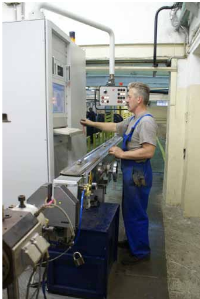
Изготовление изолированной жилы кабеля для установок погружных электронасосов
