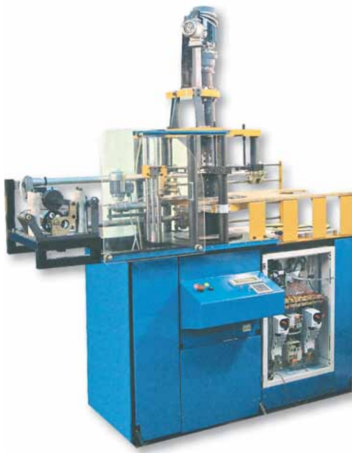
Рис.1. Изготовленная двухпозиционная автоматизированная бухтовочная машина (бухтовщик)
