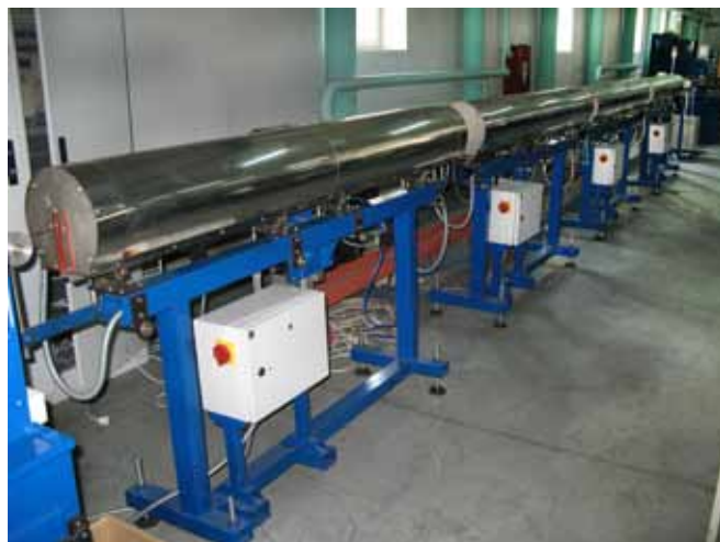
Рис. 4. Проходные печи сопротивления для термообработки проводов с пленочной изоляцией
