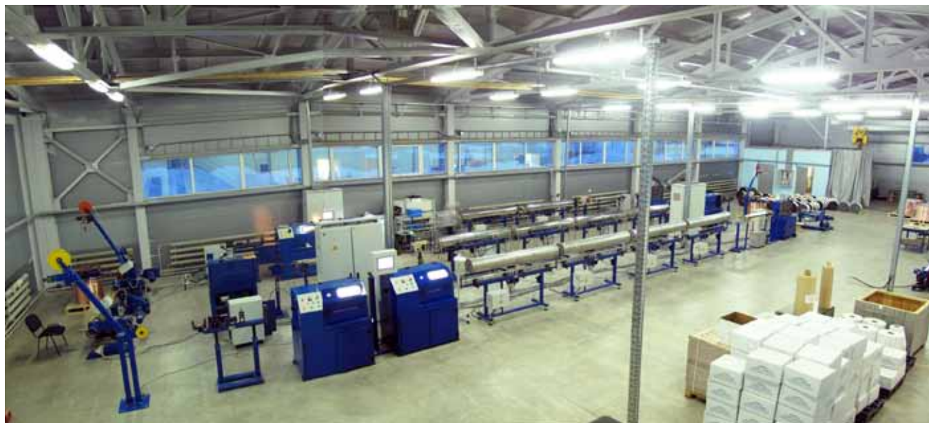
Рис. 8. Цех производства обмоточных теплостойких проводов с пленочной изоляцией
