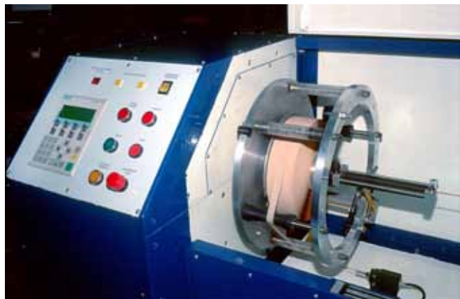
Рис. 2. Головка лентообмотчика с бобиной крестовой намотки
