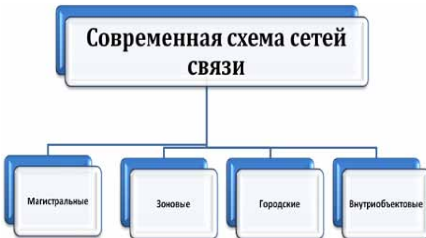
Рис. 1. Структура современных сетей связи
