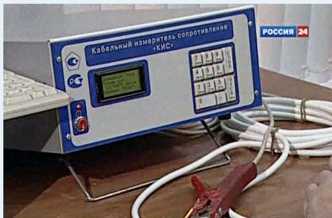
Результаты испытаний показали, что представленные образцы не соответствуют требованиям ГОСТ. Например, образцы провода ПВС 4×4 не соответствовали ГОСТ по сечению, классу жилы, коэффициенту эксцентриситета изоляции, маркировке по оболочке, маркировке на ярлыке.
