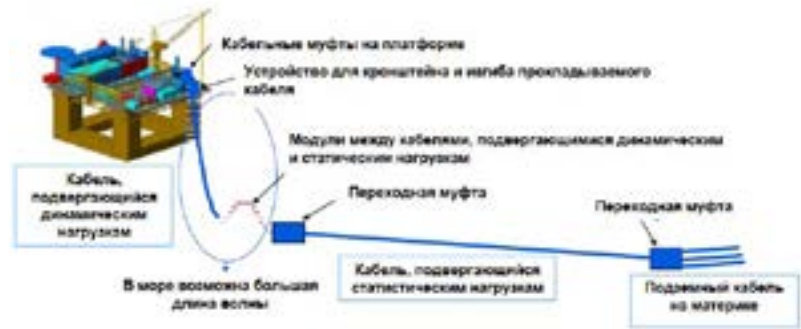
Рис. 6. Основные компоненты подводной кабельной линии переменного тока между побережьем Норвегии и нефтяной платформой Гёйа
