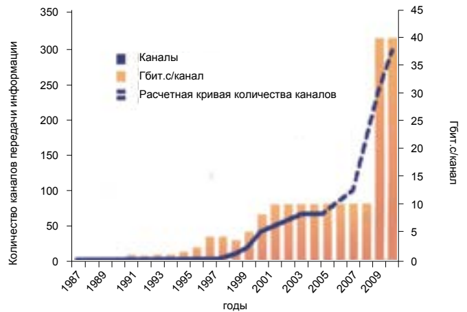
Рис. 8. Расширение полосы передачи по волоконно-оптическим кабелям за период 1987–2010 гг.
