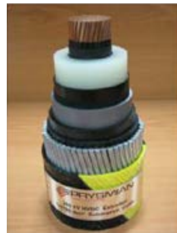
Рис. 3. Общий вид подводного кабеля с экструдированной изоляцией из сшитого полиэтилена на напряжение постоянного тока ± 200 кВ, используемого в линии электропередачи через залив Сан-Франциско (США)
