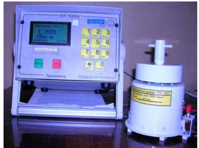
Рис. 1. Установки для измерения \epsilon и \text{tg}\delta (а) и \rho_v (б) образцов диэлектриков
