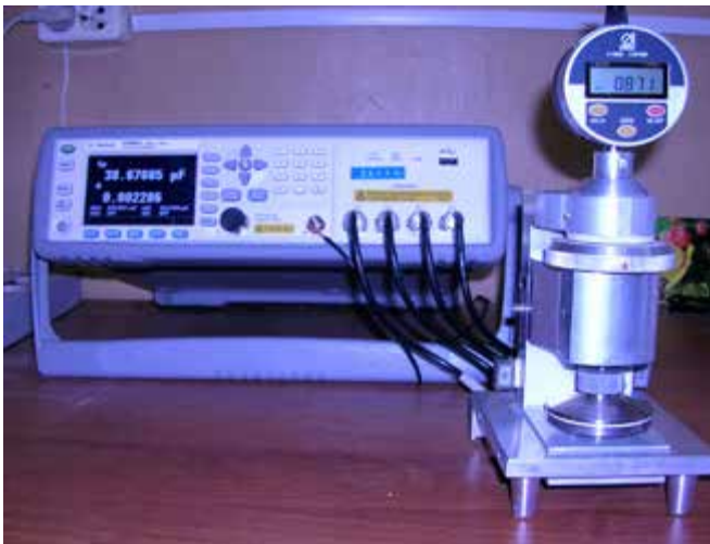
Рис. 1. Установки для измерения \epsilon и \text{tg}\delta (а) и \rho_v (б) образцов диэлектриков
