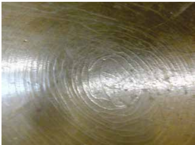
Рис. 3. Поверхностные трещины по линиям внутренних напряжений на образце ПЭ НП 153-01К
