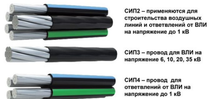
Рис. 1. Марки проводов СИП
