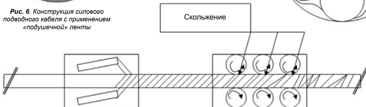
Рис. 7. Применение нетканых лент, препятствующих проскальзыванию
