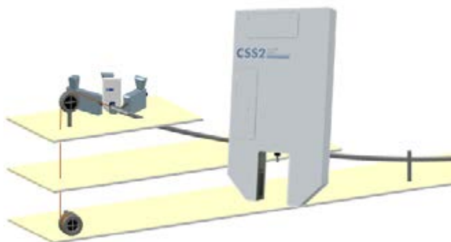
Рис. 4. Измерение чистоты расплава на наклонной линии
