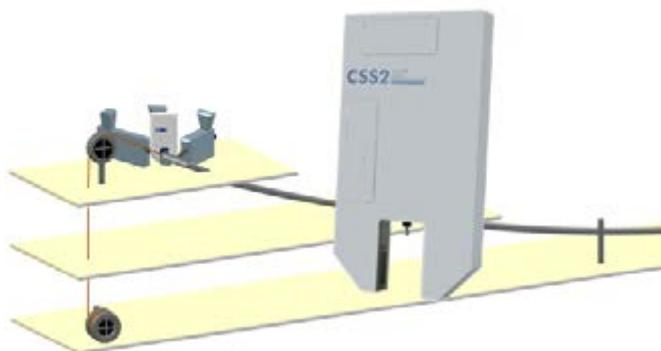
Рис. 4. Измерение чистоты расплава на наклонной линии
