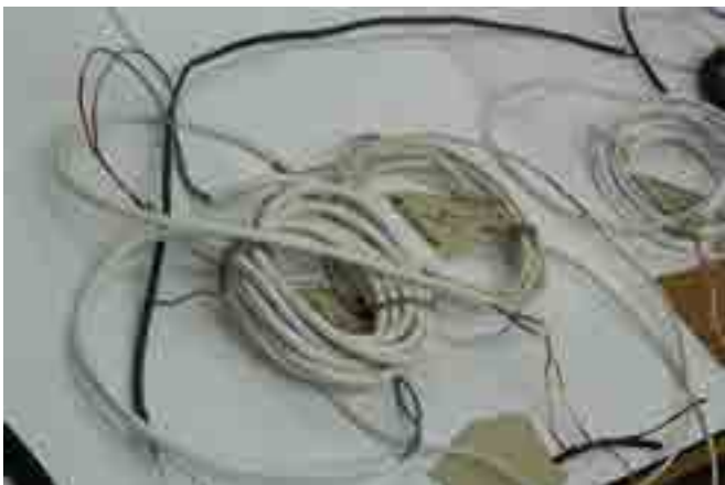
Рис. 5. Образцы КПП, отобранные для испытаний
