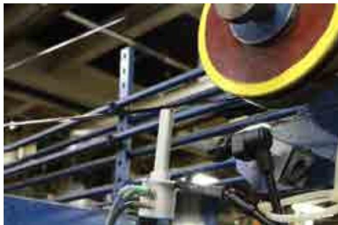
Рис. 1. Зонд NIRWiM, установленный на линию
