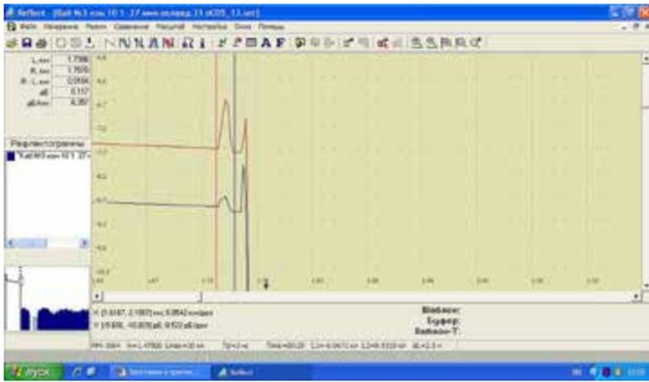
**Рис. 7.** Рефлектограмма затухания оптического волокна в прототипе кабеля СЛ-ОКМБ-03 на 31-ой минуте испытаний. (Идет охлаждение образца – температура снизилась до 31 °С)
