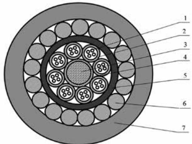
**Рис. 1г.** ОКЗнг(А)-FRHF (внешний диаметр – 14,5 мм):
