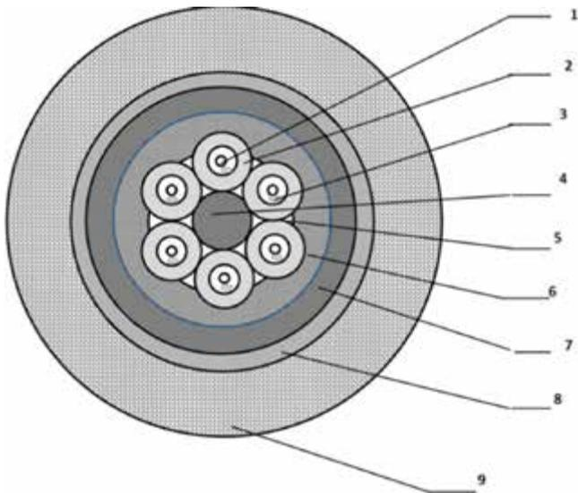
**Рис. 1а.** ОКЦпто-02/1 (внешний диаметр – 14,5 мм):
