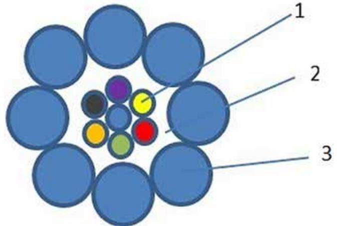
**Рис. 1в.** СЛ-ОКМБ-03 (внешний диаметр – 2,0 мм):
