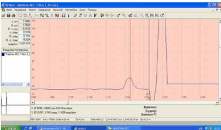
Рис. 5. Измерение температуры в момент предварительного подогрева образца диэлектрического кабеля типа ОКЦпто
