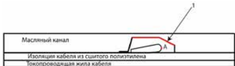
Рис. 6. Расчетная область изоляции и электродов концевой муфты (1 – граница раздела «кремнийорганическая отливка–масляный канал»)
