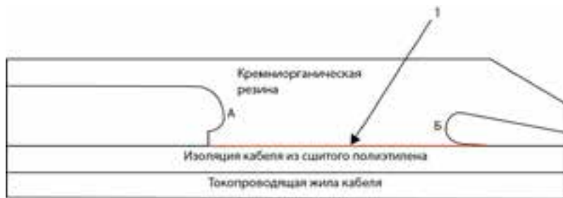
Рис. 5. Расчетная область изоляции и электродов соединительной муфты. (1 – граница раздела «кремнийорганическая отливка–изоляция кабеля»)
