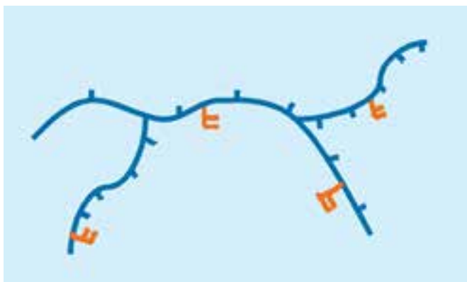
Рис. 4. Схематичная иллюстрация базового полимера Borlink™ Supercure. Оранжевым цветом обозначены двойные связи, повышающие реакционную способность
