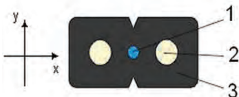
Рис. 1. Внутриобъектовый кабель марки ОВНП для широкополосного доступа: 1 – оптическое волокно, 2 – силовой элемент, 3 – наружная оболочка, 4 – общий вид (схематичный)
