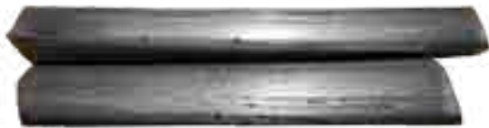
Рис. 1. Отсутствие проволоки токопроводящей жилы и несоответствие геометрических параметров элементов конструкции кабеля
