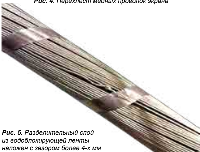
Рис. 4. Перехлест медных проволок экрана
