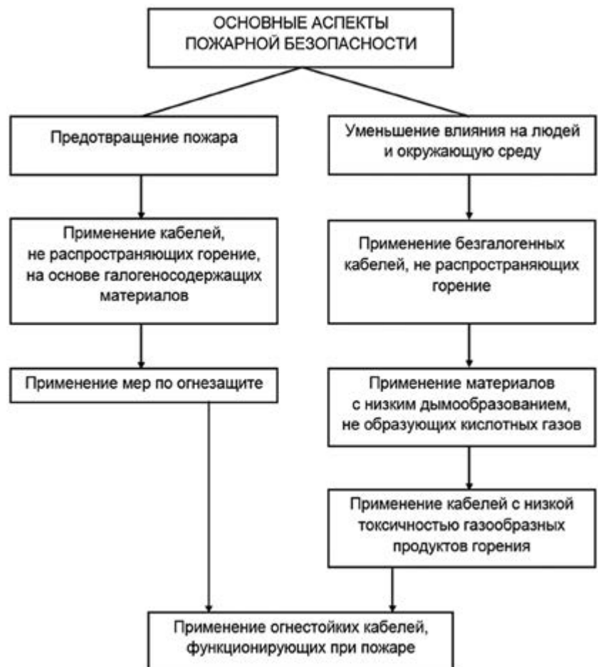
Рис. 1. Основные аспекты пожарной безопасности кабелей и проводов
