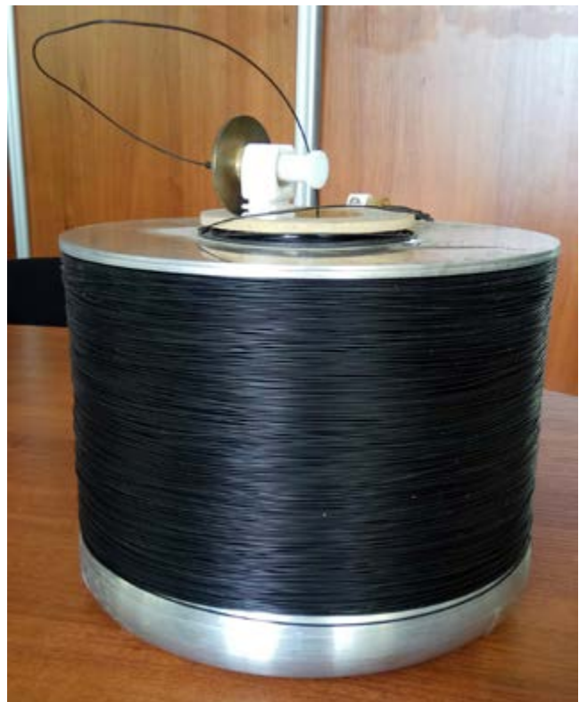
Рис. 2. Безынерционная катушка для высокоскоростной намотки оптического микрокабеля
