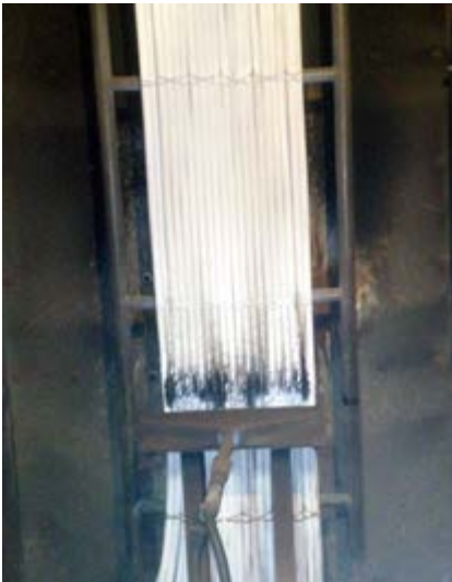
Рис. 6. Упрочнённый термостойкий огнестойкий ОК (диаметр 16 мм) на завершающей стадии испытаний на нераспространение горения при вертикальной групповой прокладке по категории А (ГОСТ ИЕС). Длина обугленного участка по окончании испытания 40 см
