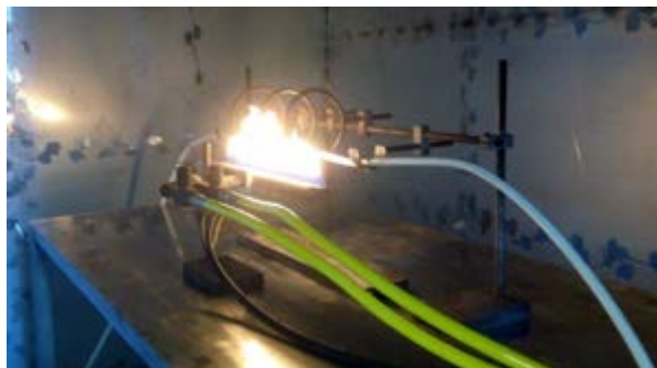
Рис. 5. Испытания ОК на огнестойкость
