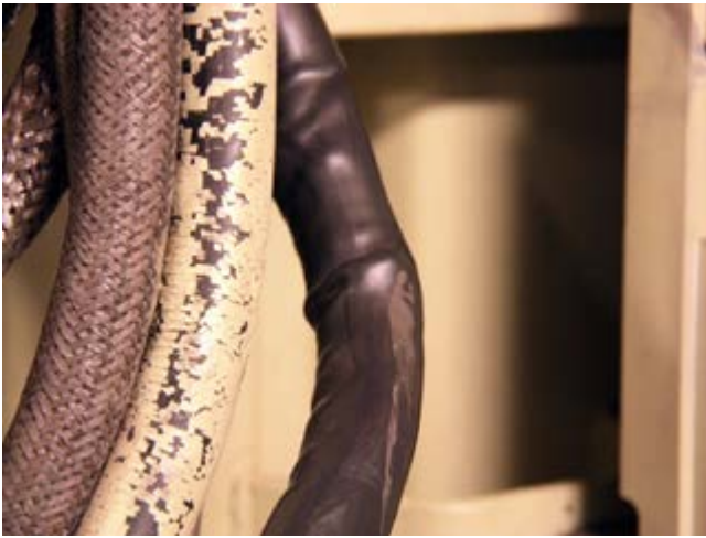
Рис. 1. Дефект вида «гофра» и последующее растрескивание
