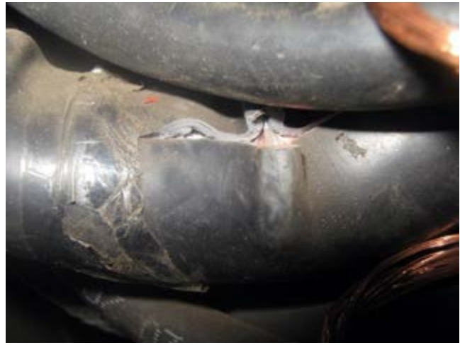
Рис. 1. Дефект вида «гофра» и последующее растрескивание
