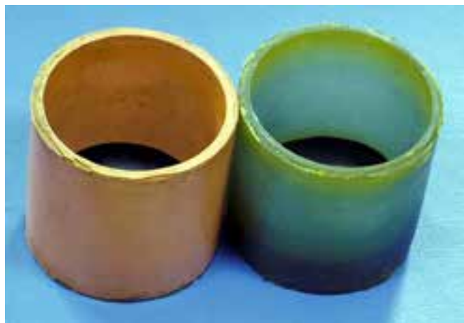
Рис. 1б. Образцы для испытания на ускоренное старение («чашки Роговского»), выполненные из ЭПР (слева) и СПЭ
