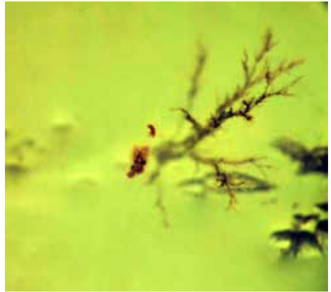
Рис. 3а. Электрический триинг, зародившийся на включении термически модифицированного полиэтилена в СПЭ
