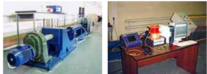
Рис. 4. Испытательная установка для растягивающей и раздавливающей нагрузки РРК-ЕК2
