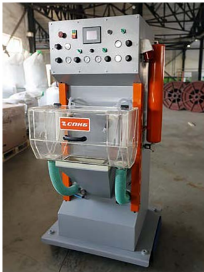
Рис. 2. Электростатическое талькирующее устройство типа ЭТУ 100×2
