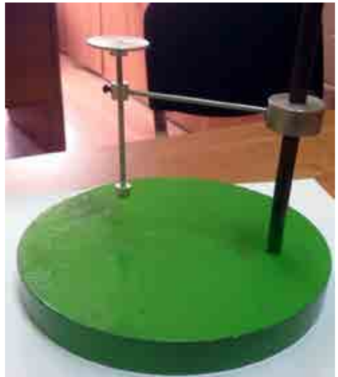
Рис. 1. Устройство для определения механической прочности керамического остатка силиконовой резины
