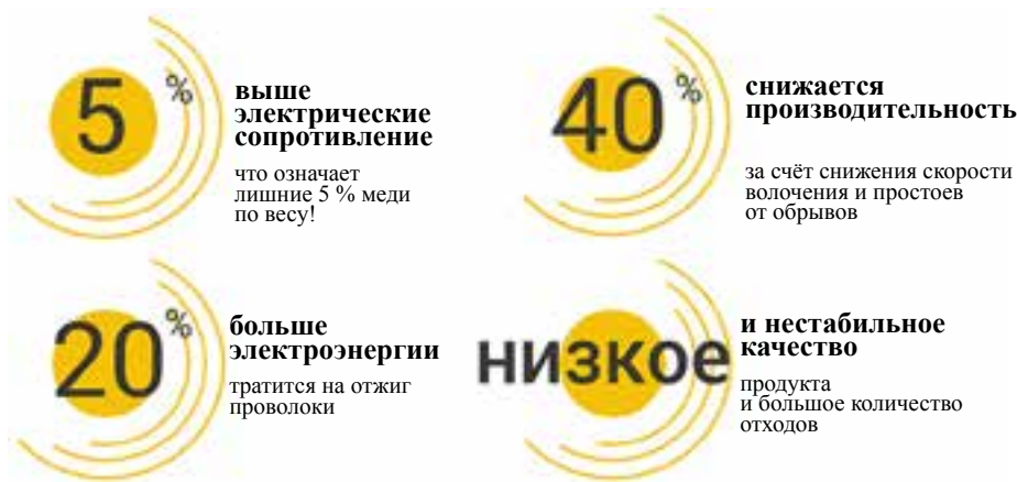
Рис. 3. Особенности использования медной катанки, изготовленной из ломов
