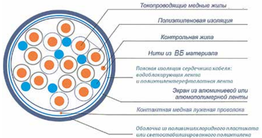
Рис. 1. Кабели для сигнализации и блокировки с водоблокирующими материалами
