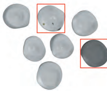
Примеси, обнаруженные с помощью оптической камеры
