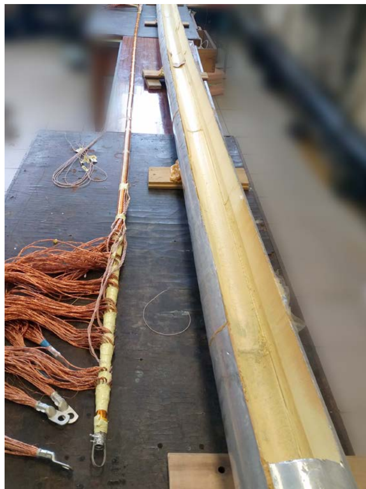
Рис. 4. Макет триаксиального ВТСП-кабеля перед установкой в криостат
