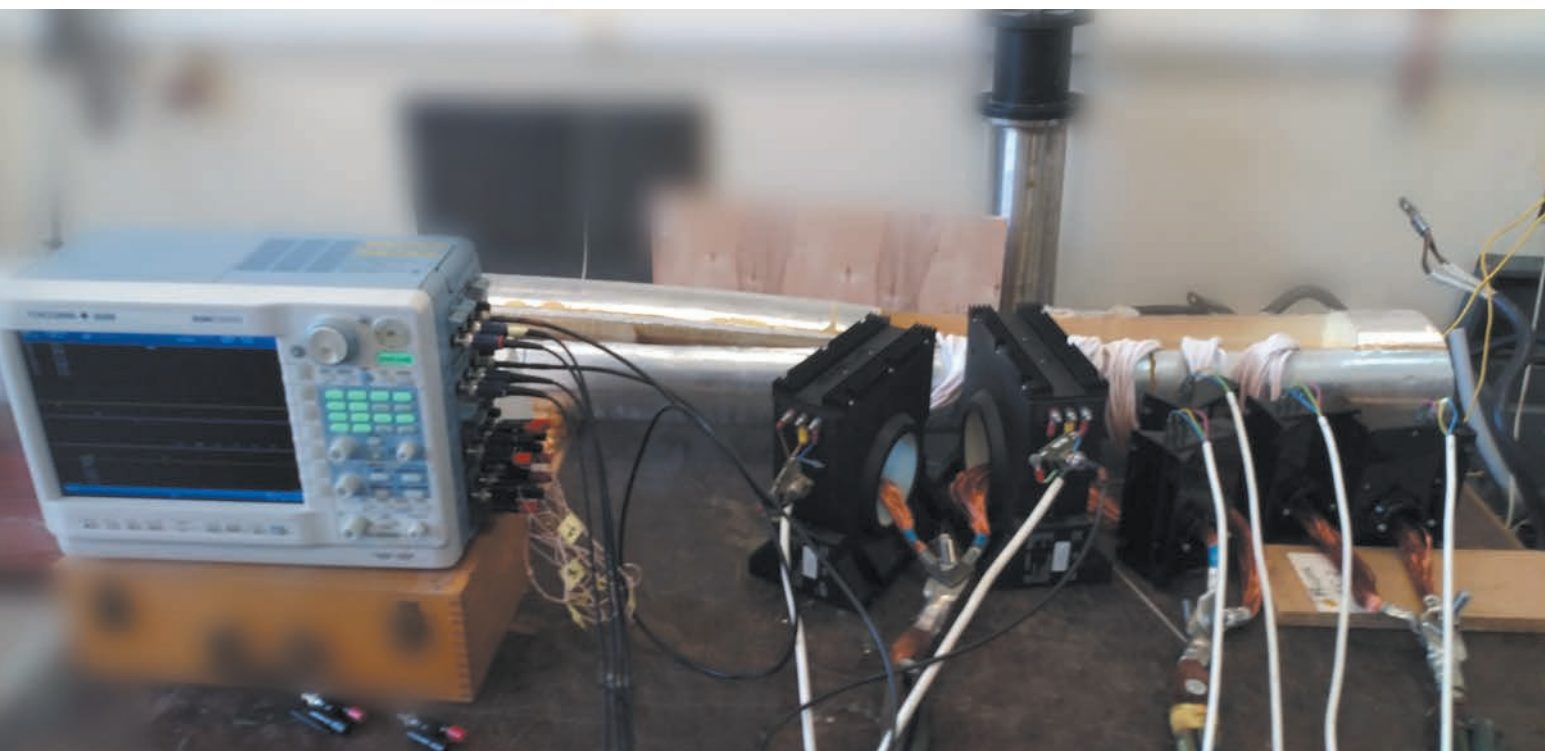
Рис. 5. Система сбора данных Yokogawa DL-850 и макет кабеля
