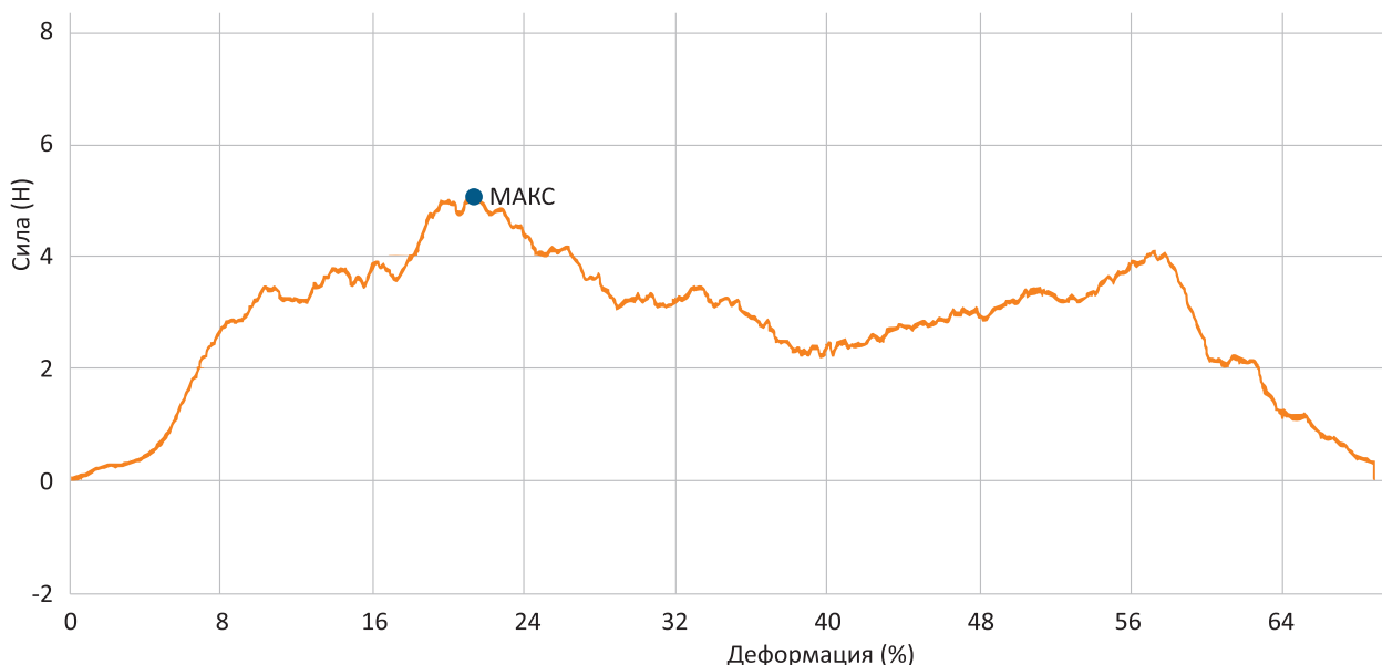
Рис. 4. Усилие на отрыв при растяжении сварного соединения медь–плёнка до окисления поверхности меди в зависимости от степени деформации
