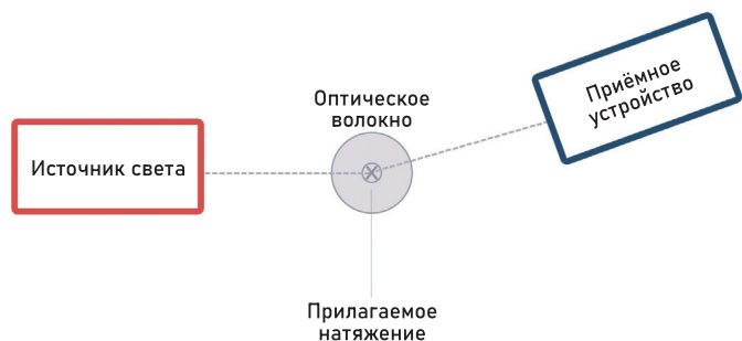
Рис. 1. Метод измерения, основанный на принципе двойного лучепреломления: натяжение измеряется по изменению поляризации света, поступающего в оптическое волокно, относительно выходящего луча двойного преломления, попадающего на приёмное устройство
