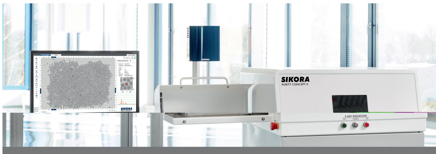
Рис. Система PURITY CONCEPT X обнаруживает металлические примеси в гранулах пластмассы и автоматически производит их оценку
